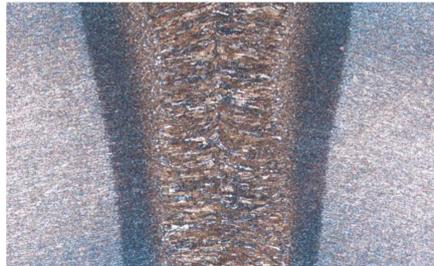
Oben: Gefüge der Lasernaht: vollständig durchgeschweißt
