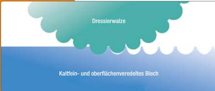
▲ Schematische Darstellung des Vorganges des Aufbringens der PRETEX®-Oberflächenstruktur
